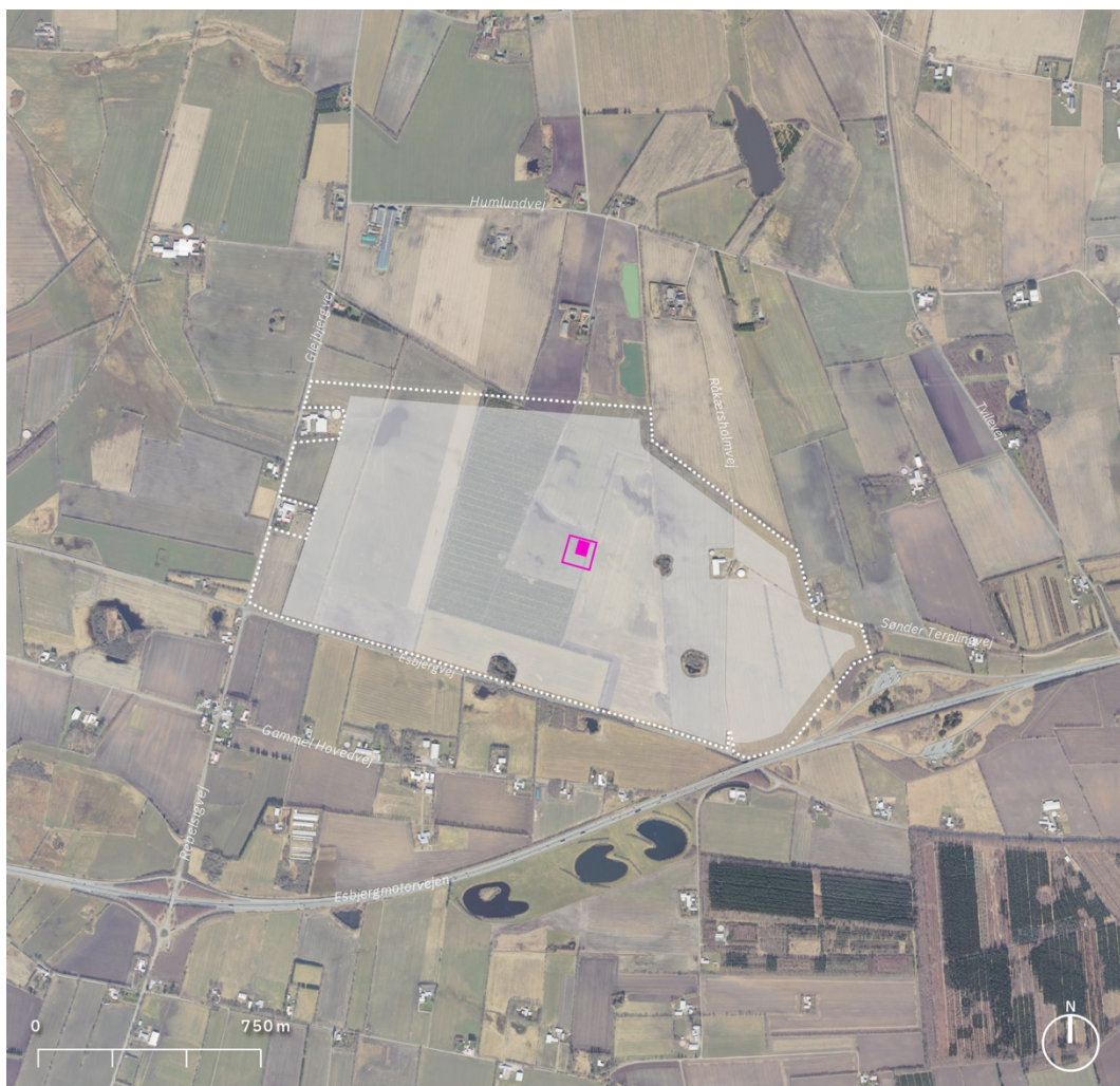
Figur 1: Afgrænsning af solcelleanlægget er vist med hvide prikker. Indenfor anlægsområdet udlægges delområder til hhv. tekniske anlæg i form af solenergianlæg, tekniske anlæg som transformatorstation og arealer der skal anvendes som vildtpassage og henligge med beplantning. Kortet viser med pink markering, placering af projektets step up transformer.
